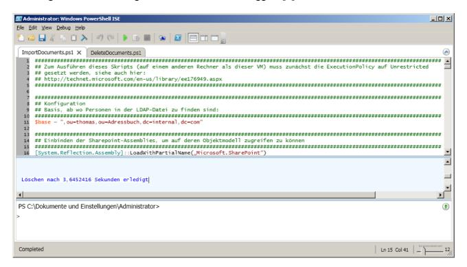
Die Aufteilung des Debuggers [2] ist ganz einfach: Oben wird der Quellcode editiert, in der Mitte erfolgt die Ausgabe der Powershell und unten können Befehle direkt eingegeben und getestet werden.
